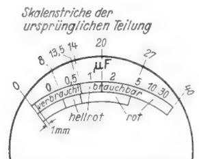
Bild 8. Skala des Instrumentes
