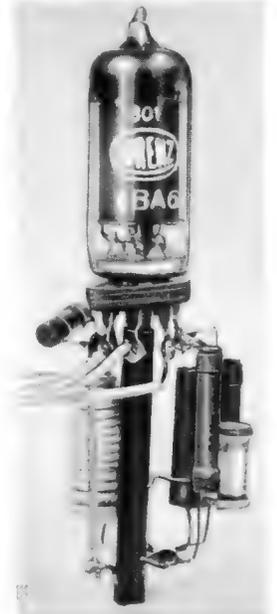
Praktische Einzelteilanordnung bei modernen Röhrenfassungen. Mit Hilfe eines Isolierröhrchens werdendie Schaltelemente in Längsrichtung zur Röhrenachse angeordnet
